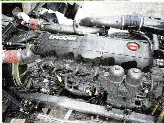
Kapalinou chlazené šestiválcové PACCAR MX mají až 375 kW (510 k)
